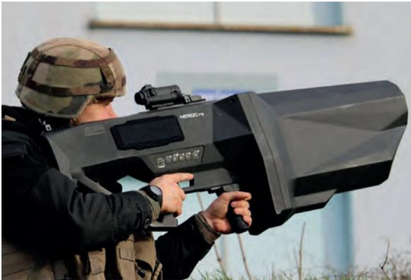
Brouilleur portable directionnel anti-drones.
