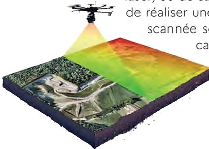
Drone équipé d'un LIDAR scannant une surface de terrain.
