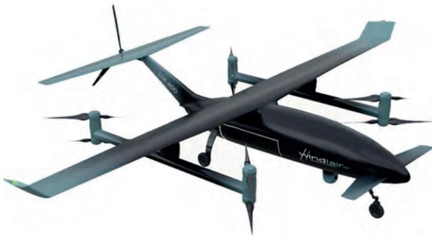
Le drone DX400, en cours de développement par Windlair, a l'ambition de conserver sa pleine capacité d'emport jusqu'à une altitude de 3000 mètres. Les concepteurs de cet appareil ont également pour volonté d'optimiser les capacités de vol à basse vitesse, ce qui est un défi sur les appareils à voilure mixte. © Windlair.
