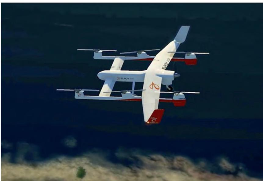
Drone Elroy Air Cargo type VTOL développé par la société californienne Chaparral. Ces drones, encore en cours de développement, ont pour ambition de transporter environ 150 kg sur une distance de 400 km.
