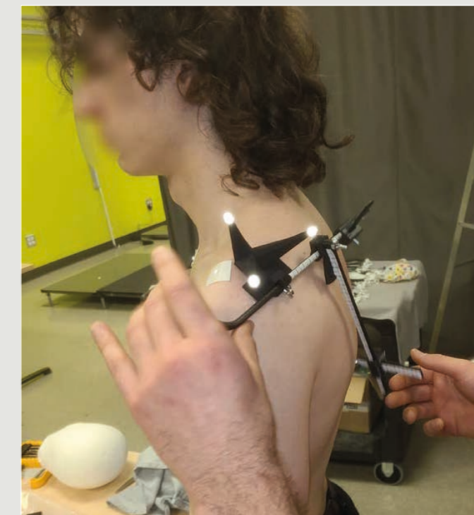
Placement du deuxième dispositif créé sur le patient pour la deuxième série de test. Il est possible de voir les marqueurs réfléchissants sur l'épaule (boules réfléchissantes)
